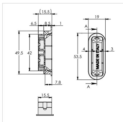
Благодаря переворачиванию контейнера возможна регулировка по прижиму  $\pm 1$  мм
