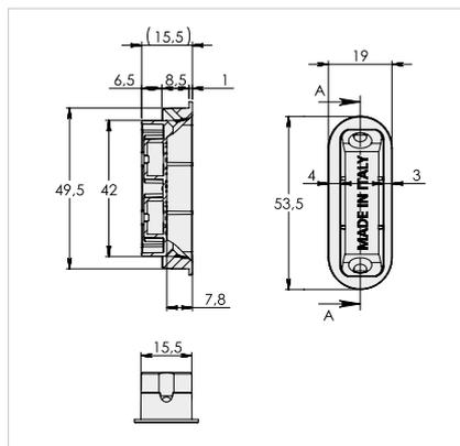
Благодаря переворачиванию контейнера возможна регулировка по прижиму ±1 мм
