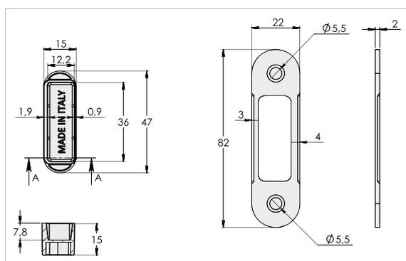
Благодаря двойному переворачиванию контейнера и ответной планки возможна регулировка по прижиму  $\pm 2$  мм
