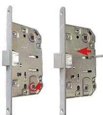
Переведите замок в положение закрыто. С помощью отвертки надавите на пластмассовый блок и вытолкните язычок до его полного выхода из корпуса замка
